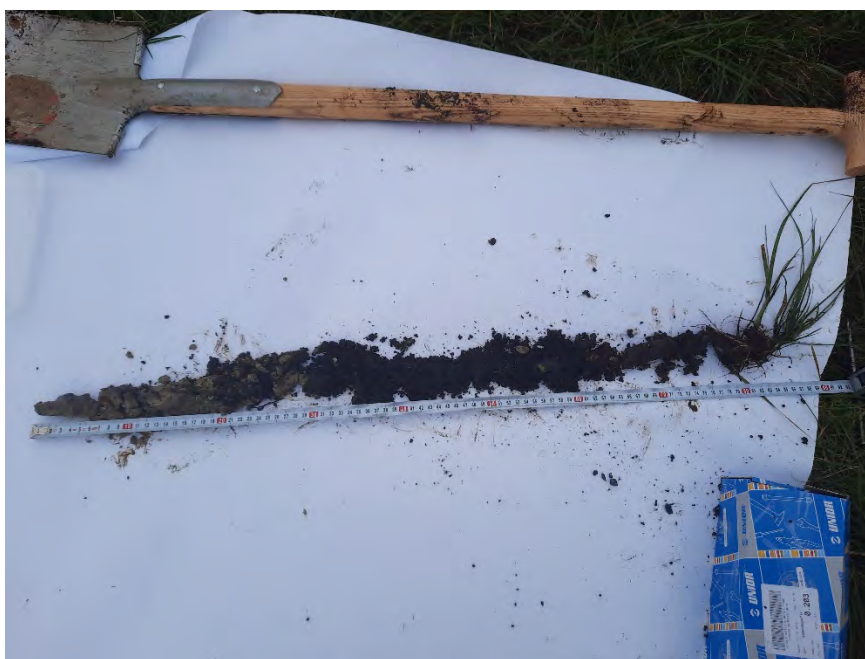
Slika 17: Pridobljen profil prsti s pomočjo pedološkega svedra, S. Stružnik
