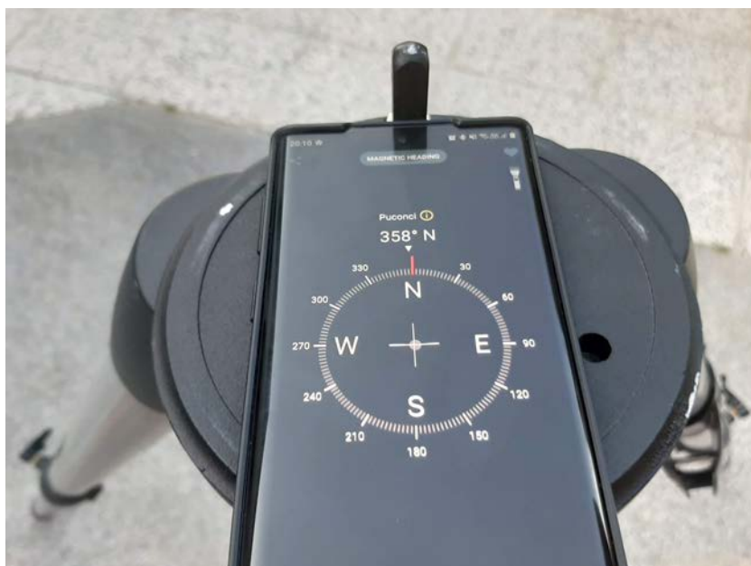
Slika 6: Prikaz uporabe aplikacije kompasa za usmerjanje glave stojala proti severu
