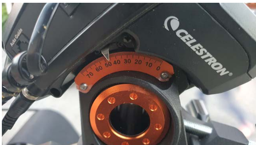
Slika 8: Nastavitev višine teleskopa v kotnih stopinjah, ki je hkrati višina Severnice in se ujema z geografsko širino
