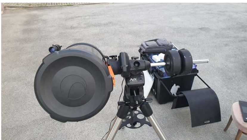
Slika 7: Teleskop v ravnovesni legi na osi rektacsenzije
