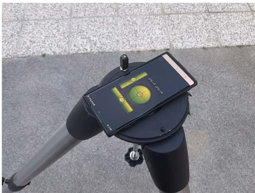
Slika 5: Uporaba aplikacije vodna tehtnica (Bubble level) za določanje ravnovesja
