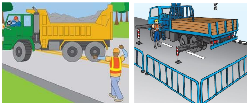
Slika: signalist z dobro vidnim odsevnim jopičem / zavarovanje nevarnega območja
