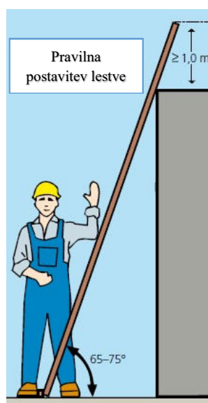
Slika: varna postavitev lestve
