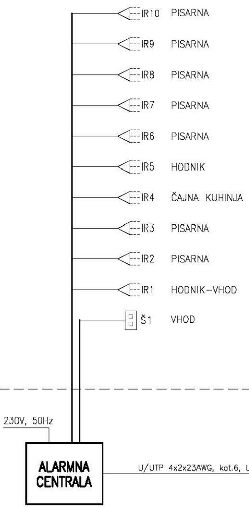
NEOZNAČENI KABLI OD ALARMNE CENTRALE OZ. RAZŠIRITVENEGA MODULA DO POSAMEZNIH ELEMENTOV SO ALARM 36762 2x0,5+4x0,22mm. IZVEDBO POVEZAV SE USKLADI PRED IZVEDBO GLEDE NA IZBRANI SISTEM VLOMNEGA VAROVANJA.
