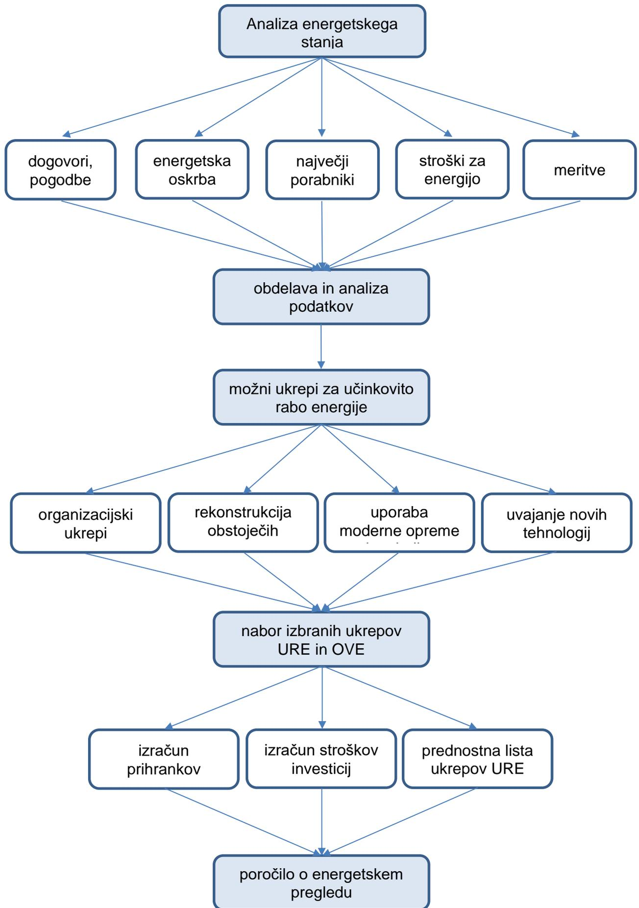
Slika 1.1: Shematski prikaz poteka izdelave energetskega pregleda
