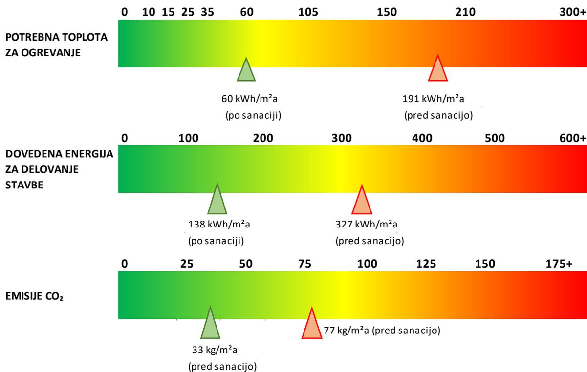
Slika 0.2: : Primerjava energetskih kazalnikov – večnamenski objekt
