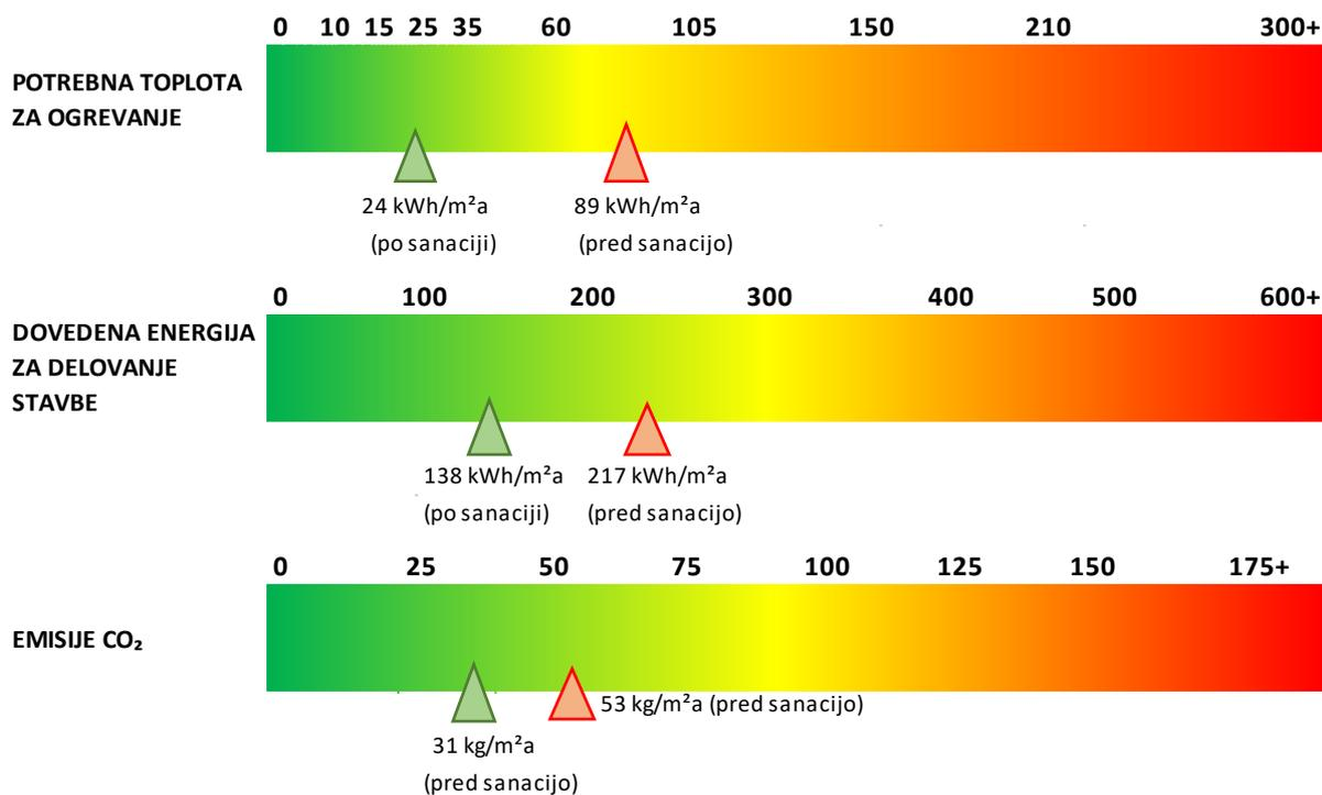
Slika 0.1: Primerjava energetskih kazalnikov – nastanitveni objekt
