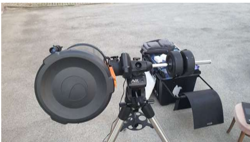
Slika 7: Teleskop v ravnovesni legi na osi rektacsenzije
